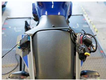
Big Data: Beim Reifentest fährt auch feinstes MotoGP-Mess-Equipment von 2D mit
